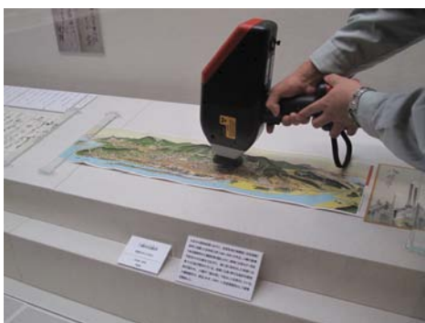
モバイル型蛍光X線分析装置による調査 (保存科学分析室)
