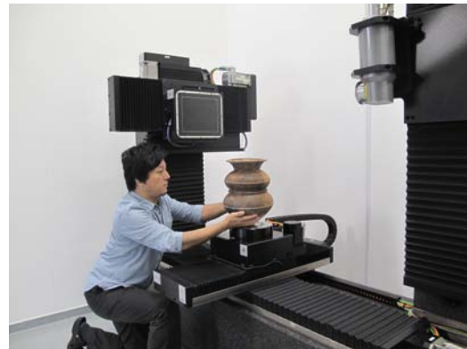
X線CTスキャナによる分析の様子(光学計測室) X線を使った撮影で、透過画像、断層画像、三次元画像を得ることができ、立体的に内部形状を探ることができます。
